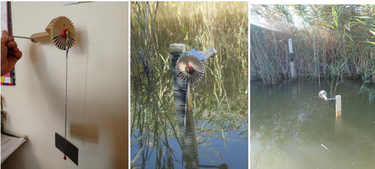
**Abb. 51. Strömungsindikator, montiert an der Stelle WindB vor einer Wildkamera.**
