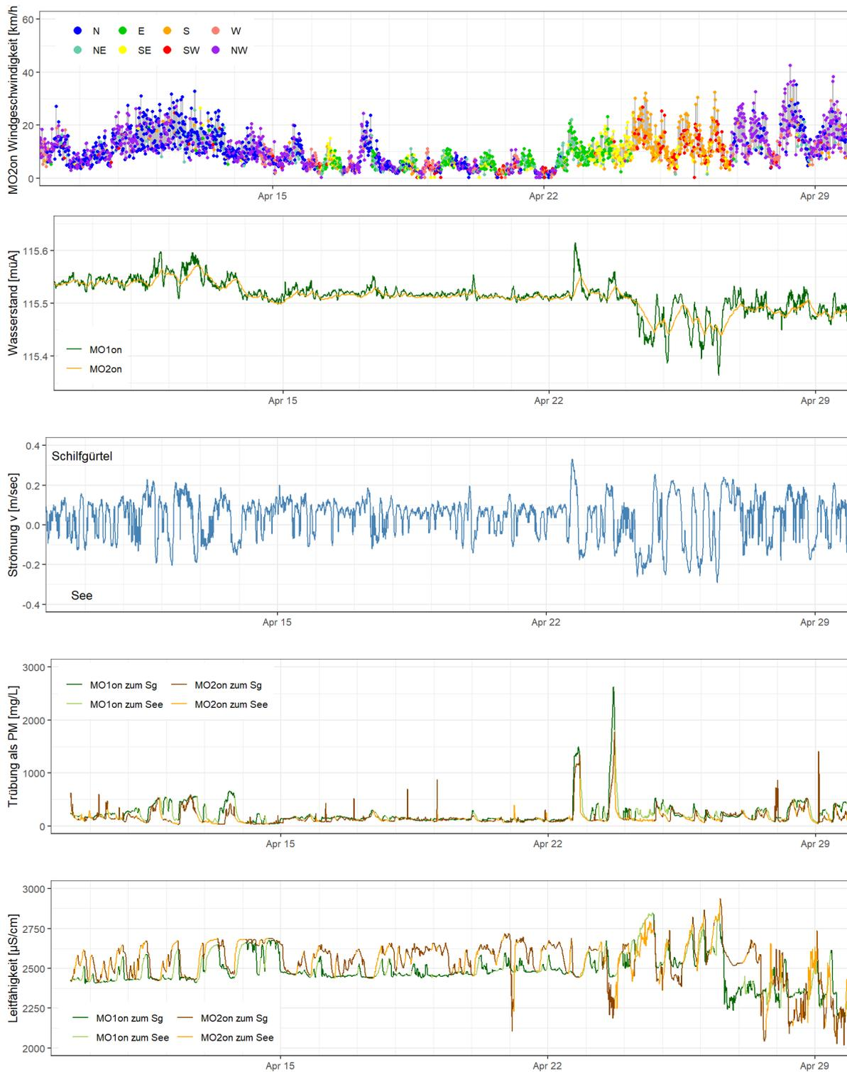
**Abb. 35.** Detaildarstellung des Strömungsmodells und relevanter Parameter an den Stationen MO1on und MO2on im Zeitraum 10.-29. April 2019. Windgeschwindigkeiten und -richtung, Wasserstand, Strömungsgeschwindigkeit im Kanal, Trübung als partikuläres Material (PM) berechnet, Leitfähigkeit. Die Leitfähigkeits- und PM-Kurven sind nach Zeiten der berechneten Ein- („zum Sg“) bzw. Ausströmung („zum See“) unterteilt.
