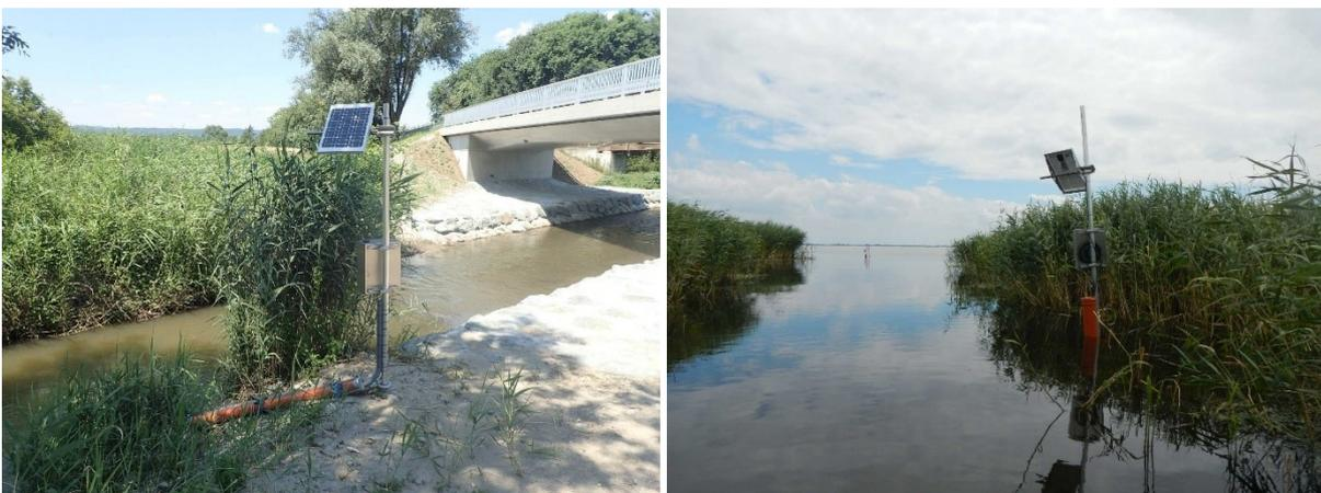
**Abb. 3. Fotos der Wasserqualitätsmessstationen im Untersuchungs-bereich Wulka. Linkes Bild: WU4on stromauf der Brücke. Rechtes Bild: WU1on am Mündungsbereich des Kanals in Blickrichtung See.**
