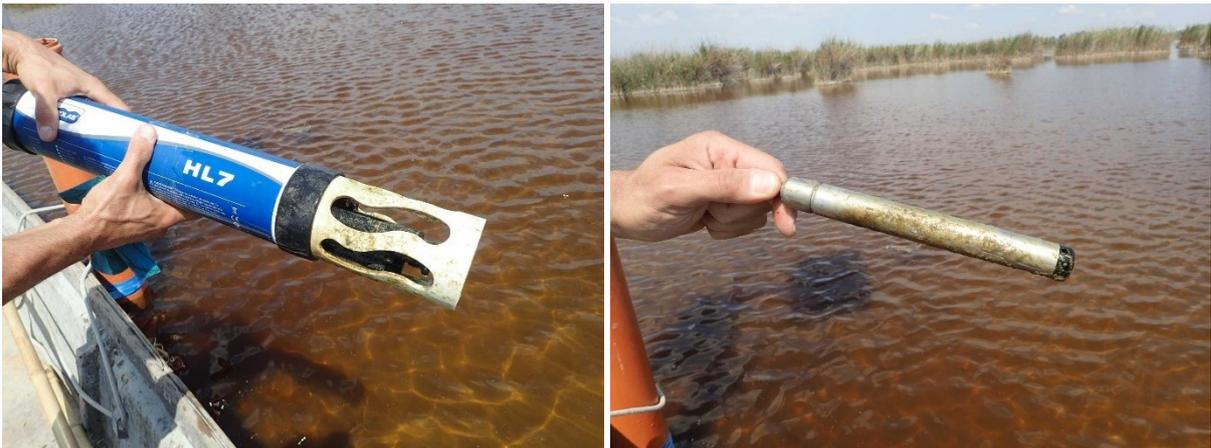
**Abb. 10. Multiparametersonde HYDROLAB HL7 (links) und Wasserstandssensor OTT PLS (rechts).**
