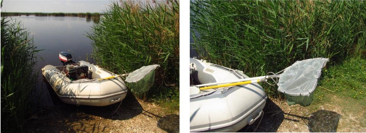
**Abb. 37. Schlauchboot mit Elektroaggregat (links), Anodenring mit kleinem Durchmesser und Kescher mit Netzgazeaufsatz für Jungfischerhebungen (rechts).**
