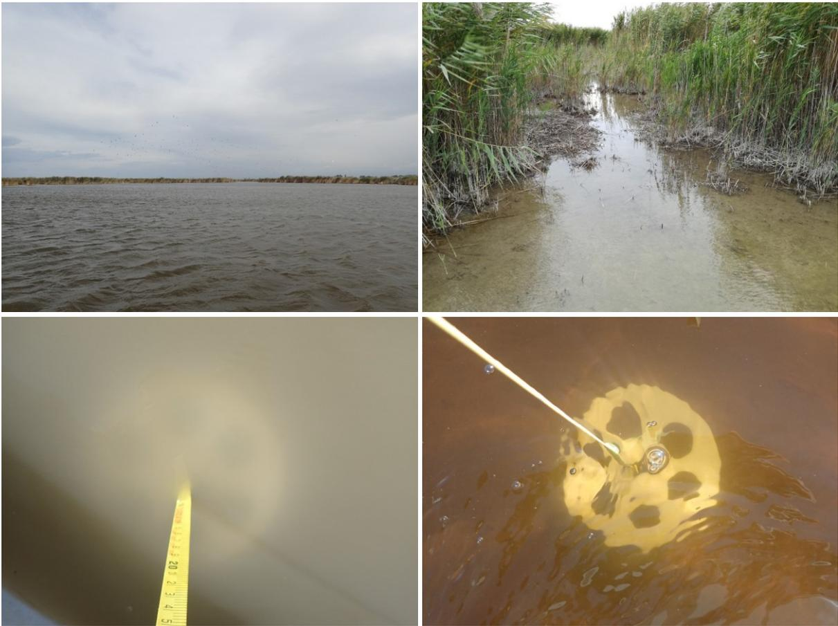
**Abb. 6.** Links oben: Ruster Poschn bei Illmitz, rechts oben: verlandeter Kanal vom Ruster Poschn Richtung See, links unten: Sichttiefenmessung mittels Secchi-Scheibe an der seenahen trüben Messstelle IL2 am 09.04.2018, rechts unten: Sichttiefenmessung an der landseitigen Messstelle IL5 am 09.04.2018.
