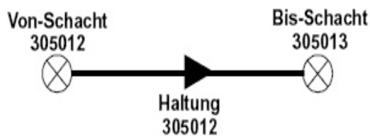
Abb. A-1 - 2 Beispiel Schacht-/Haltungsbezeichnung
